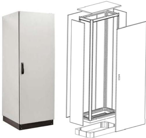
Konstrukcija ormana se izrađuje od čeličnih profila, a stranice i vrata od hladno valjanog čeličnog lima, debljine 1,5-2mm, hemijski obrađen i plastificiran strukturnom bojom u nijansi prema DIN RAL 7035-EP, nanošenjem i pečenjem poliesternog praha na temperaturi od 200°C.
